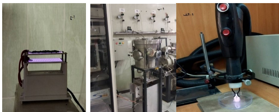
شکل ۱. الف: تخلیه پلاسمای گلایدین آرک. ب: سامانه پلاسمای رادیو فرکانسی. ج: پلازما بر پایه تخلیه سد دی‌الکتریک
